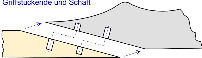
Stabilisierung der Verbindung durch Setzen kleiner Holzstifte,
